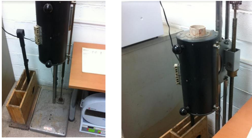
Figura 2.- Horno vertical marca ADAMEL para crecimiento de cristales.
